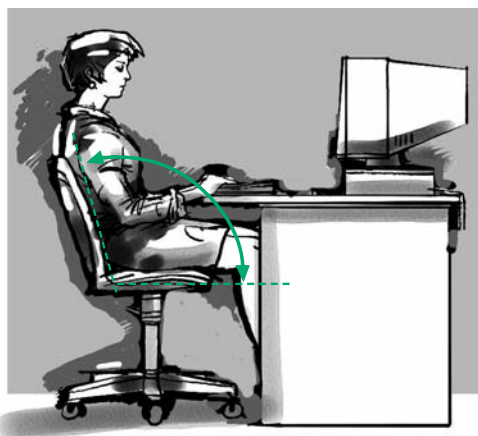
Figura 11 - Postazione di lavoro corretta al videoterminale: la schiena è leggermente inclinata all'indietro
